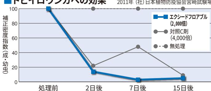
【試験概要】 ●発生状況：少発生（区内中央に成幼虫約500頭を放飼） ●品種：ヒノヒカリ（移植；6月26日） ●区制：1区100m<sup>2</sup>（9.1×11.0m）反復なし（3箇所調査） ●処理方法：9月5日（乳熟期）に背負式動力噴霧機を用いて114L/10aを散布 ◆調査方法：9月5日（処理前）、処理2、7、15日後に、区内3箇所のそれぞれ10株に生息している虫を粘着板へ払い落し、成・幼虫数を調査
