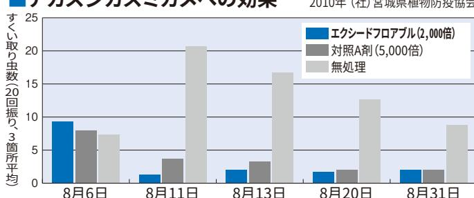
【試験概要】 ●発生状況：多発生 ●品種：ひとめぼれ（移植；5月17日） ●区制：1区121.6m<sup>2</sup>（19m×6.4m）反復なし（3箇所調査） ●処理方法：8月7日（穗揃期）と8月14日に動力噴霧機にて120L/10aを散布 ◆調査方法：1回自薬剤処理前日（8月6日）、処理4日後、6日後（2回目処理前日）、2回目処理6日後、17日後に、各区20回すくい取りし、捕獲虫は計数後のすくい取り位置に戻し、場所が重ならないように3箇所を調査した
